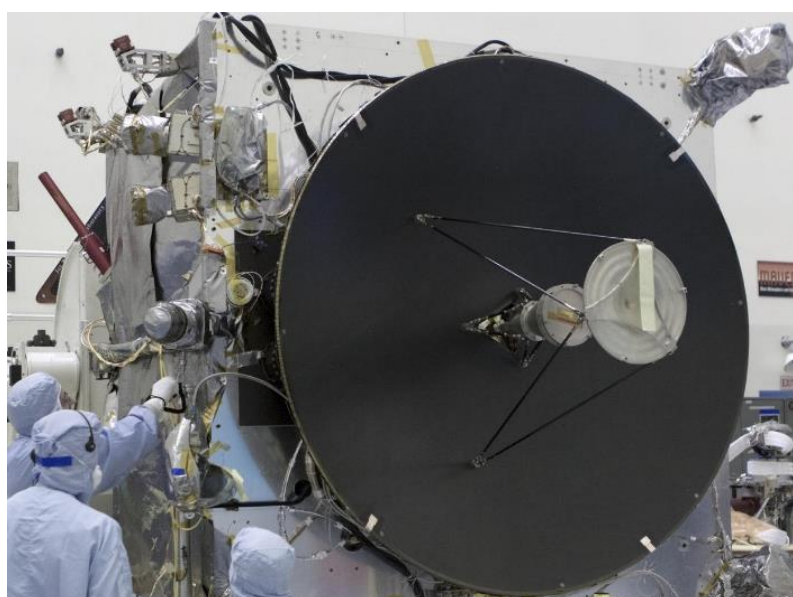
ภาพที่ 2-2 สายอากาศสำหรับดาวเทียมสื่อสาร MAVEN spacecraft 2
