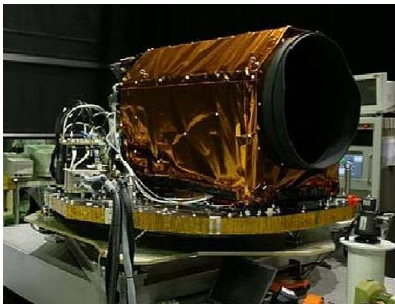
ภาพที่ 2-1 กล้องถ่ายภาพดาวเทียม สำหรับใช้ในภารกิจของดาวเทียมไทยโชต 1
